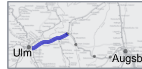
3-gleisiger Ausbau Neu-Ulm – Neuoffingen, v_{max} 200 km/h
